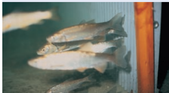
Abb. 12.6: Verhalten von potamodromen Fischen an einem 20 mm-Rechen bei v < 0,5 m/s (Laboruntersuchung ARBEITSGEMEINSCHAFT GEWÄSSERSANIERUNG 1998)
