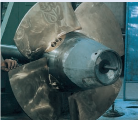
Abb. 4.14: Kaplan-Laufrad mit verstellbaren Flügeln
