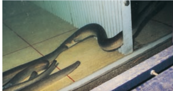
Abb. 12.3: Ein Blankaal passiert einen 20 mm - Rechen (Laboruntersuchung ARBEITSGEMEINSCHAFT GEWÄSSERSANIERUNG 1998)
