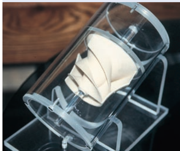
Abb. 12.36: Modell einer fischschonenderen Turbine, die derzeit bei Alden Lab. (Mass., USA) getestet wird. Die Maschine wurde als Alternative zu vertikalen Kaplanmaschinen für große Wasserkraftwerke konzipiert.
