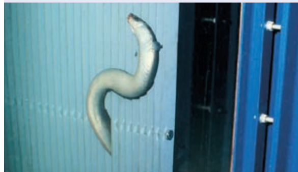
Abb. 12.4: Aal, der bei einer Anströmgeschwindigkeit > 0,5 m/s an einen 20 mm-Rechen angepresst wird (ARBEITSGEMEINSCHAFT GEWÄSSERSANIERUNG 1998)
