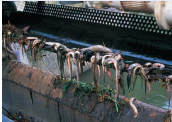
Abb. 7.7: Abwandernde Aale, die gegen den Rechen gepresst und von der Reinigungsmaschine erfasst wurden
