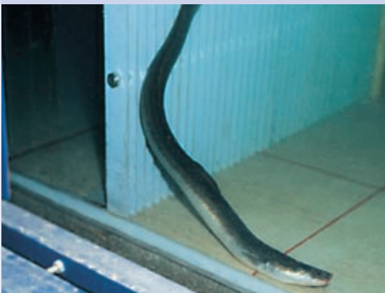
Abb. 12.22 - 12.24: Verhaltensbeobachtungen im Strömungslabor zur Funktionsweise der Bottom Gallery®: Vor der Barriere kehrt der Aal um, entflieht sohlennah in Richtung Oberwasser und findet die in Fließrichtung offene Sohlenschwelle
