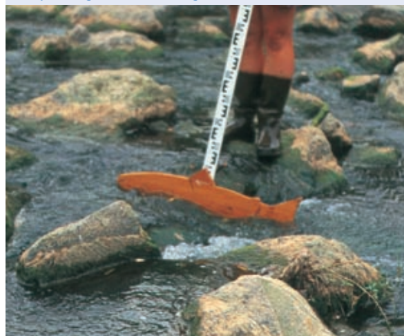
Abb. 10.38: Bei engen Steinabständen ist die Passierbarkeit von Rampen für größere Fische eingeschränkt
