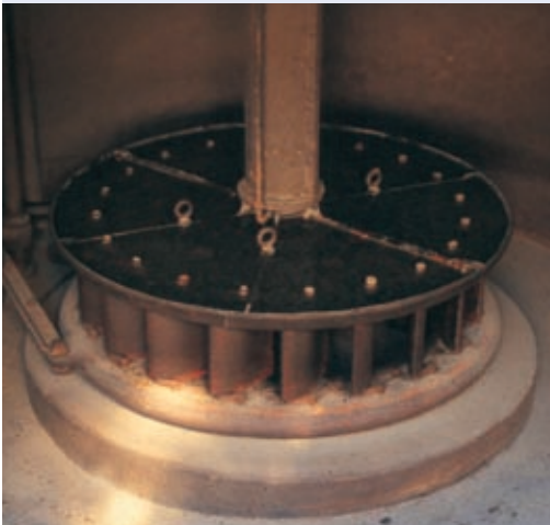
Abb. 4.10: Francis-Schachtturbine für kleine Fallhöhen
