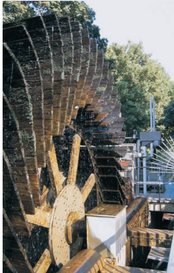
Abb. 4.6: Unterschlächtiges Wasserrad (Zuppingerad der Pleußmühle in Düren)
