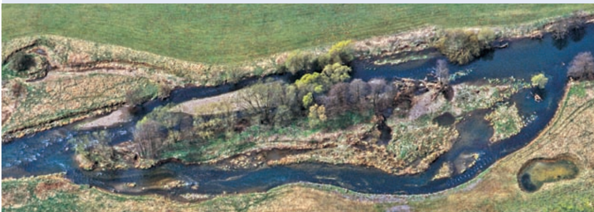
Abb. 10.3: Gewässertypgerechte Entwicklung eines Standortes an der oberen Lahn: die ursprünglich vorhandenen Furkationen stellen sich wieder ein und bilden durchwanderbare Gewässerarme mit natürlichem Sohlengefälle. Die Gewässerarme sind gegenüber Fischaufstiegsanlagen, die das Gefälle lokal konzentrieren, weniger wartungsintensiv und ökologisch hochwertiger.
