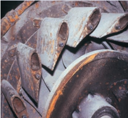
Abb. 4.8: Francis-Turbine: Leitschaufeln und Laufrad
